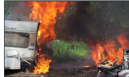
Avstand på 3 m mellom vognene. Nabovogna blir antent pga strålevarmen frå den overtente vogna. Tid: 20 min.
