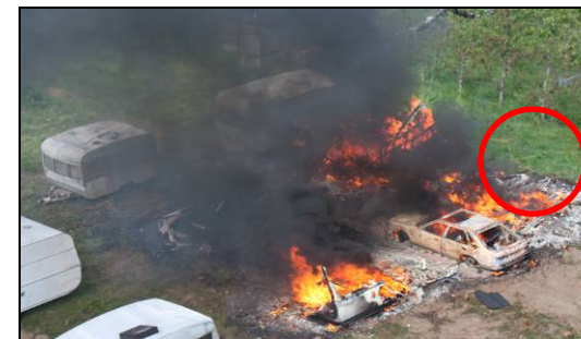
Nabovogner er utbrende. Raud sirkel viser kor brannen starta. Tid: 25 min.
