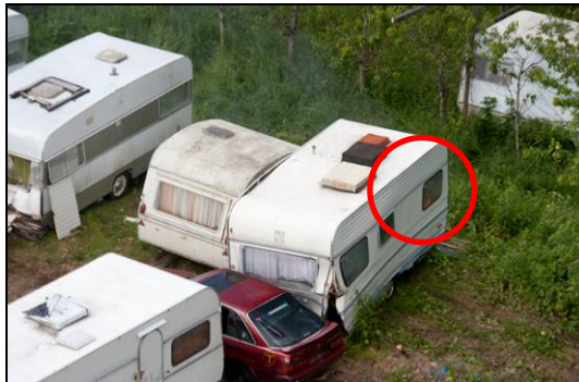
Påtent campingvogn, raud sirkel viser kor brannen starta. Tid: 0 min.
